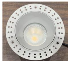
トリムレス枠上にネジ穴があります。枠を固定後、表面を石膏等で埋め合わせて枠外観を同化させたのち、LED照明本体を取り付けることができます
