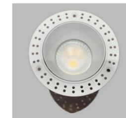
トリムレス枠上にネジ穴があります。枠を固定後、表面を石膏等で埋め合わせて枠外観を同化させたのち、LED照明本体を取り付けることが出来ます
