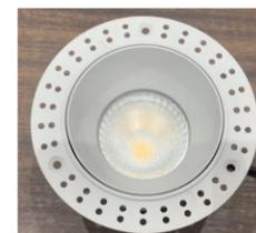
トリムレス枠上にネジ穴があります。枠を固定後、表面を石膏等で埋め合わせて枠外観を同化させたのち、LED照明本体を取り付けることが出来ます
